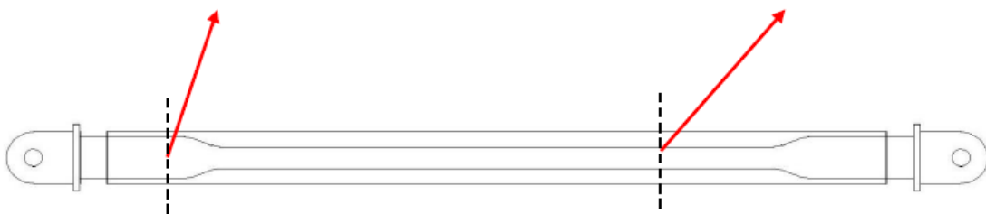
نمای هسته مهاربند به همراه اتصال پینی
