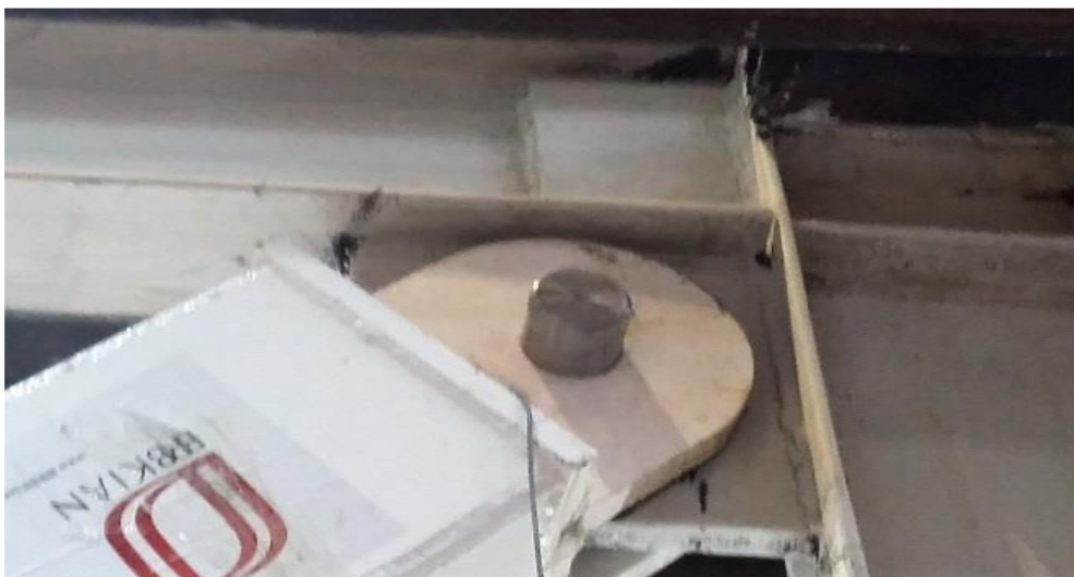
شکل ۱-۰: تغییر شکل ورق صفحه اتصال و از بین رفتن خروج از مرکزیت
