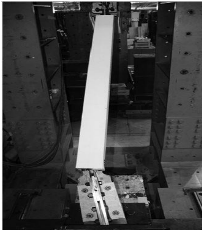
شکل ۹-۰: کمانش کلی مربوط به اتصال مهاربند کمانش تاب مرجع [۴۰]
